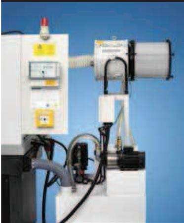
Installation externe de filtrage d'huile avec réservoir et pompe à haute pression.
