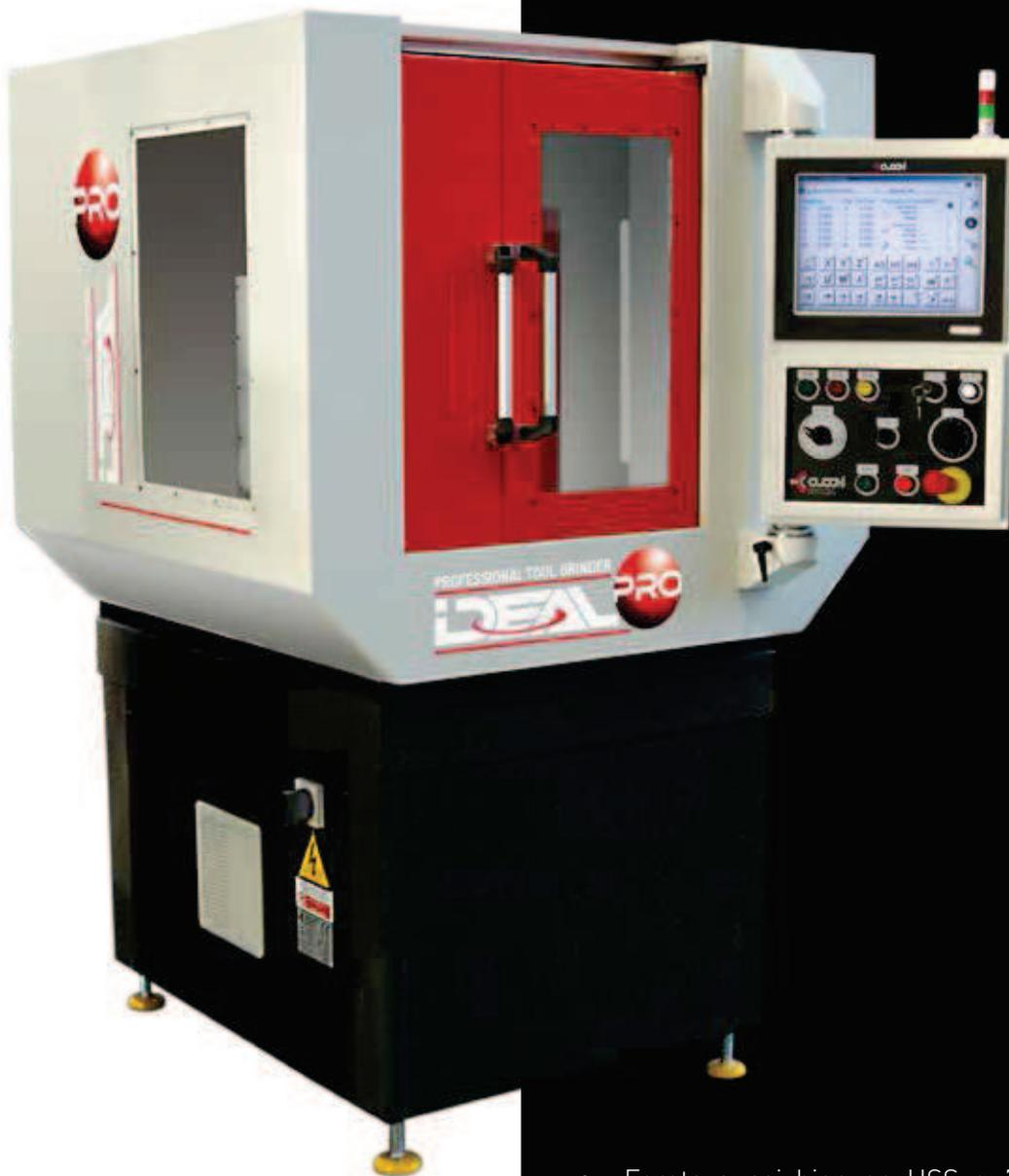
Avec un socle et un montant en granit, les affûteuses IDEAL et IDEAL PRO offrent, en un peu plus d'un mètre carré, toute la technologie nécessaire, pour reproduire les géométries de plus en plus complexes que les outils modernes exigent.
