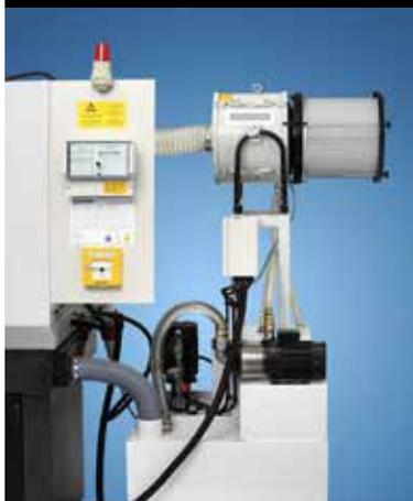
Impianto esterno di filtraggio olio con serbatoio e pompa alta pressione. Aspiratori fumi e nebbie d'olio (opzione)
