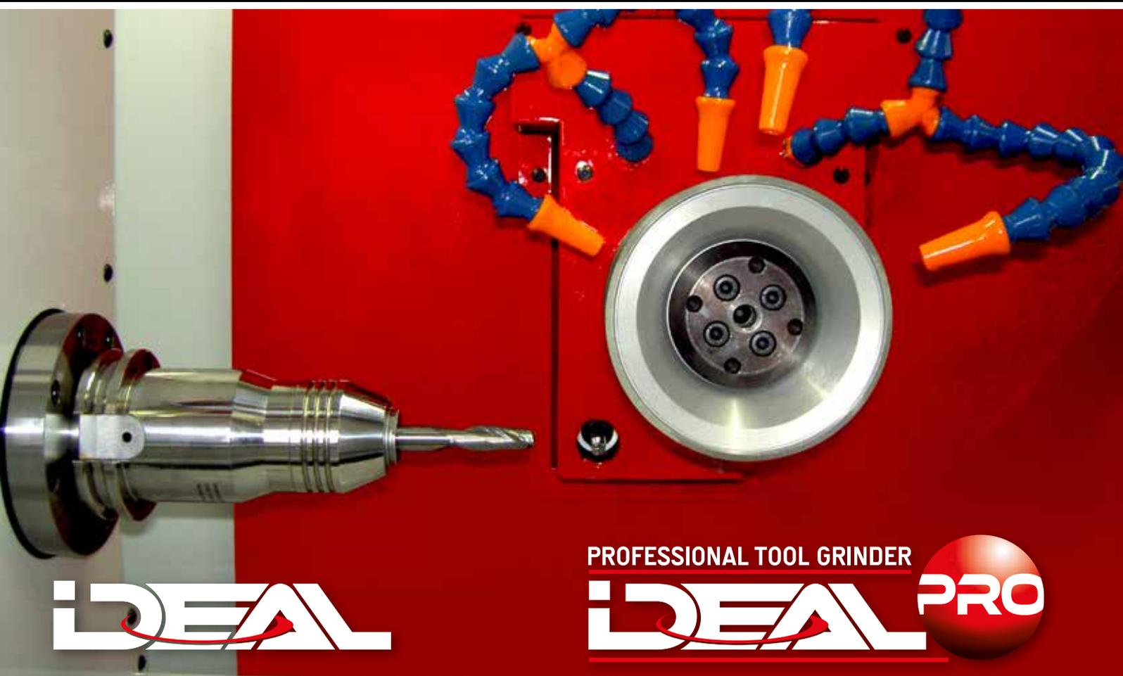
ELETTROMANDRINO PORTAMOLA CON POTENZA 1,5 KW OPPURE 3,2 KW CON LA POSSIBILITÀ DI MONTARE FINO A 3 MOLE
